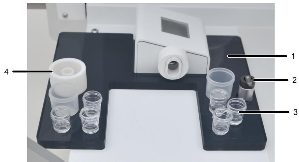
Figure 6 Rack avec dispositif de dosage de liquides
