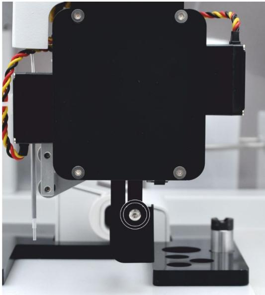
1. Enlever le capot de protection figurant à l'arrière du grappin. Pour ce faire, desserrer la vis Allen.
