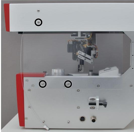
1. Retirer le dispositif de dosage de liquides, si nécessaire.
