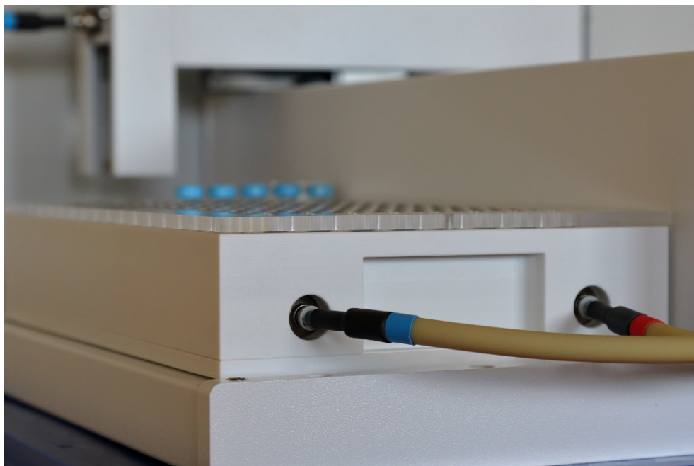
Fig. 17 Tablette porte-échantillons thermostatisable - Raccordements
