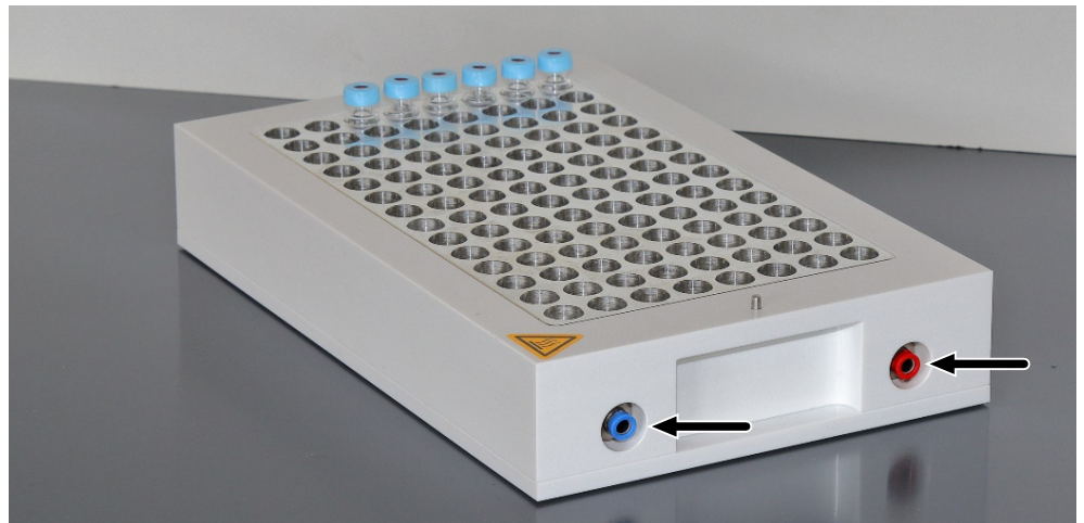
Fig. 7 Tablette porte-échantillons thermostatisable
