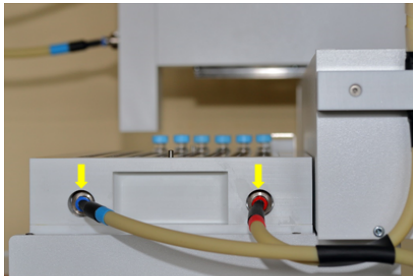
Fig. 23 Raccord sur la tablette porte-échantillons thermostatisable
