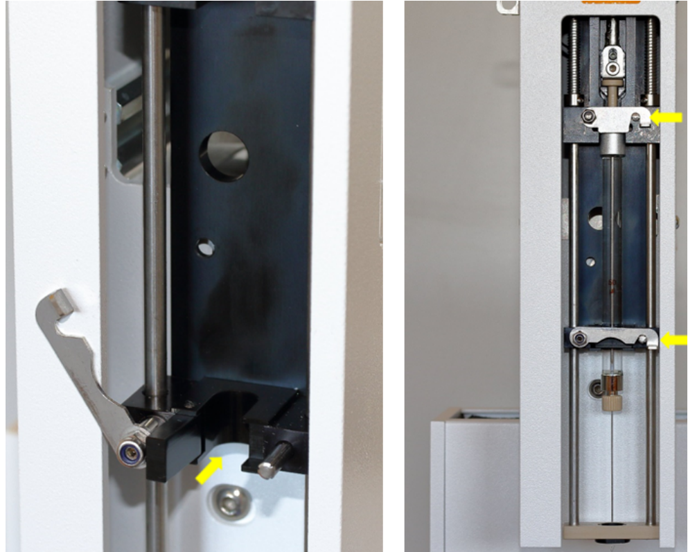
Fig. 24 Adaptateur de seringue et languettes de verrouillage.
