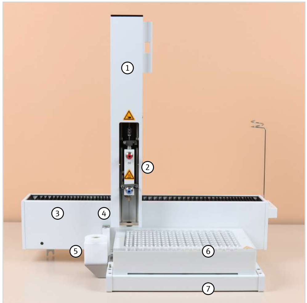
Fig. 2 Composants principaux du distributeur d'échantillons
