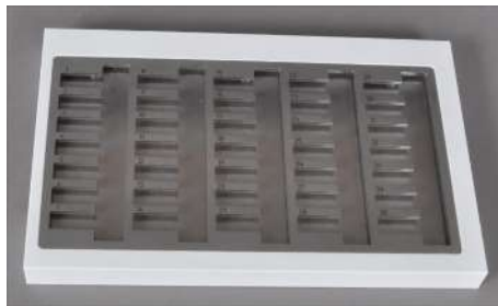
Fig. 15 Tablette porte-échantillons pour les matières solides et les échantillons AOX
