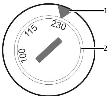
图 5 设备底部的电压选择开关
