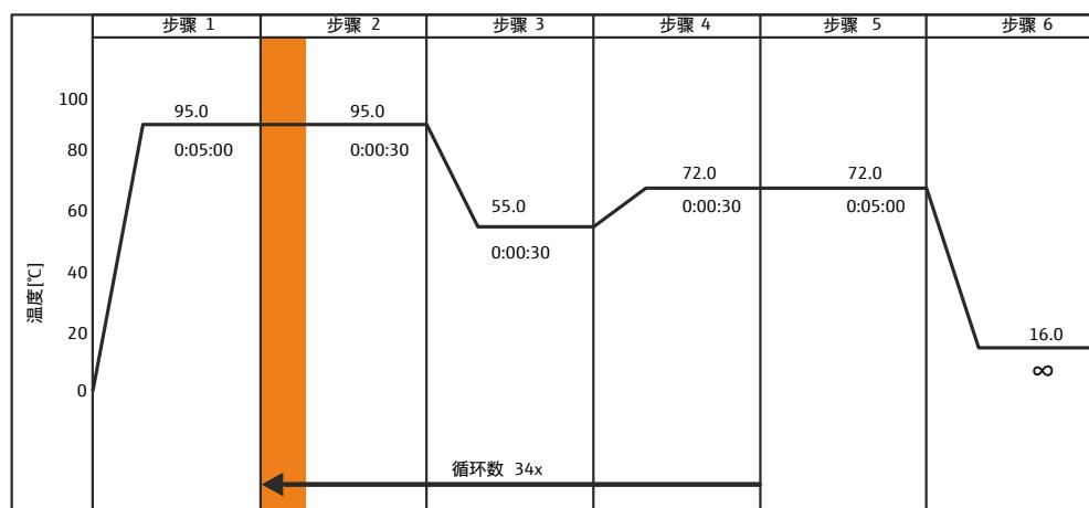
图 17 带循环的程序（图形化视图）
