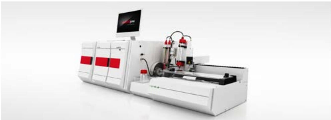
Der multi EA 4000 bietet echte Makro-Elementaranalytik! Präzise – Zuverlässig – Komfortabel. Völlig unkompliziert können Sie die Parameter TS, TC, TX, TOC, TIC, EC und AOC in organischen und anorganischen Feststoffen bestimmen. Der multi EA 4000 analysiert Feststoffe im Handumdrehen, wie z. B. Bodenproben, Sedimente, Baumaterialien, Brennstoffe, Aschen, Polymere, Abfälle, Katalysatoren, Mineralien und Düngemittel.
